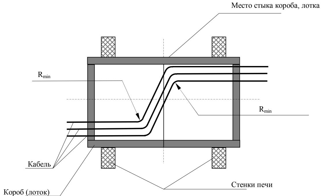
$R_{min}$  – минимальный радиус изгиба кабеля (мм) определяется в соответствии с технической документацией на кабель.
